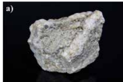
Resim 2, a) Şelitin gün ışığı altında görünümü, (Gang mineralleri ile beraber, Şeliti çıplak gözle gangtan ayırt etmek zor) b) UV ışığı altındaki görünümü (parlak mavimsi beyaz kısımlar şelittir)
