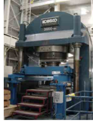
1980'lerde KOBELCO tarafından üretilen HPHT presi
