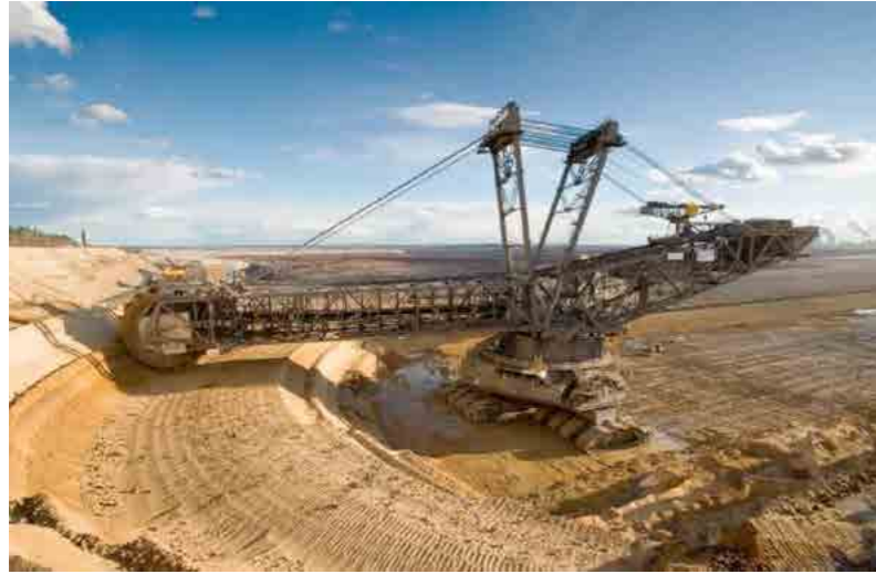
Şekil 1: Güvenlik hem insanlar hem de makineler için en önemli faktördür: Açık ocak madenciliğinde kullanılan döner kepçeli ekskavatör
