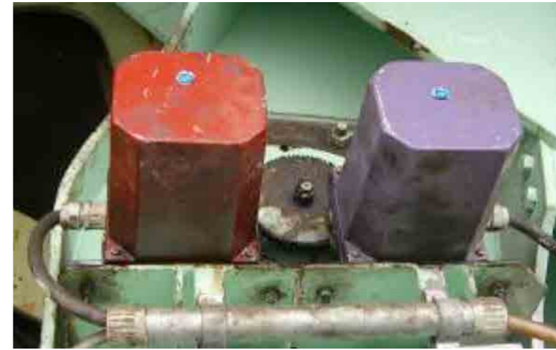
Şekil 2: Eski kurulum: Bir adet dişli çark tarafından döndürülen iki adet mil sınır anahtarı.
