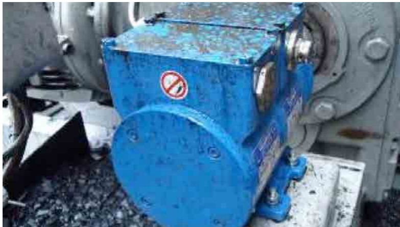
Şekil 4: Günümüzün yeni çözümü: Yeni bir kapline ve ayrıca üretilmiş bir destek yapısına sahip U-ONE-SAFETY kodlayıcı sistemi.
