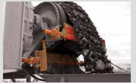
Bir mühendislik buluşu olan bant sıyırıcıları, temas alanı, temas açısı ve baskı kuvvetini aynı muntazamlıkta koruyarak her türlü malzemeyi ucun ömrünü azaltmadan bant yüzeyinden temizliyor.
