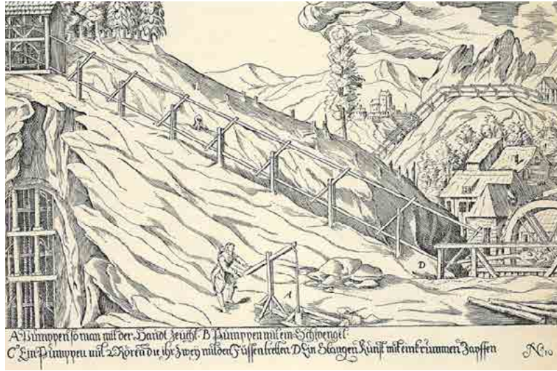
Resim 8 - Resimin ortasında aşağıda bir işçi tarafından elle çalıştırılan bir pompa (el tulumbası) görülmüş. (A). Solda bir kuyunun içinde pompa tesisleri var. O pompalar resmin sağında kenarda görülen çarktan hareketini alan (yukarı sola doğru meyille kuyu başına uzanan) çubukların (D) ileri geri hareketi ile çalışıyor.
