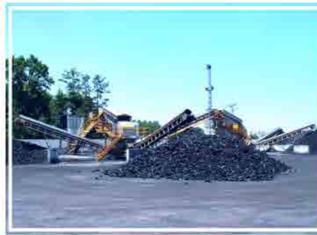
KÖMÜR ELEME ve SINIFLANDIRMA TESİSLERİ
