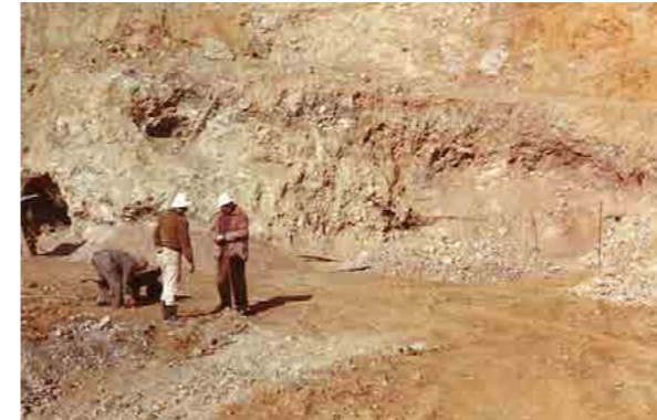
Resim. 15 - Meşebükü açık ocakta Maden Mühendisi Mehmet Mustafa Yeni ile Ocak Başçavuşu Cafer Başpınar üretim konusunda konuşuyorlar. Resmin ortasında sağda diren üstü ayrılmış takoz mal yığı, solda daha önce sürülmüş yeraltı galerilerinin boşlukları görülüyor.
