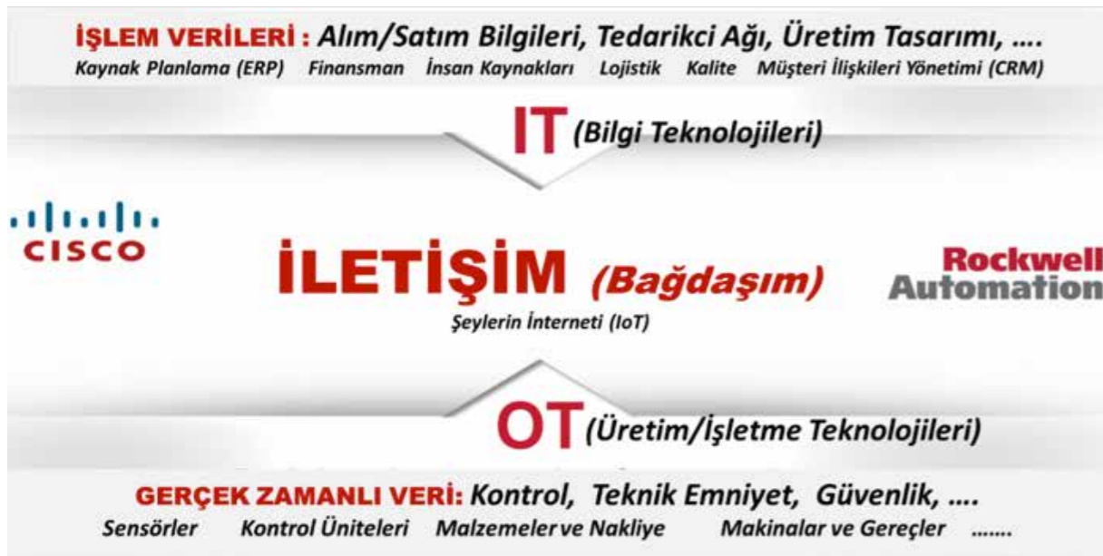
Şekil 1 - Bilgi Teknolojileri (IT-OT) Ağı Kavramı (Rockwell Automation şematigi, 1 Haziran 2016 TMD Semineri)
