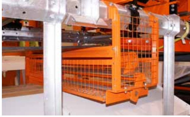
(Şekil 1) Geri dönüş rulosu etrafındaki muhafaza, konveyör teknisyenlerinin erişimini sınırlıyor.
