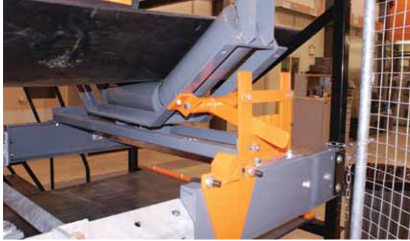
(Şekil 8) "Tarak" braketi, hizalama makarasının ayarlanmasını kolaylaştırır.
