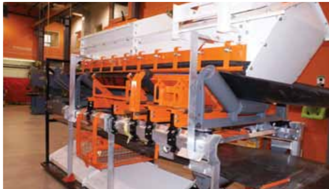
(Şekil 9) Bakımı kolay bant desteği, uygun kurulum, denetim ve bakım uygulamalarına olanak sağlar.
