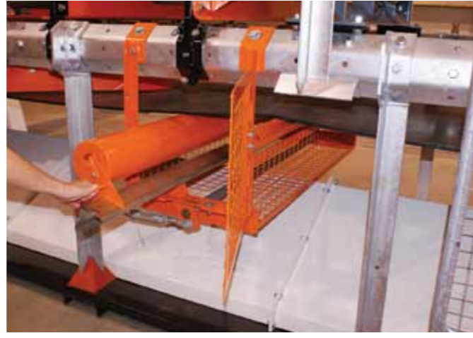
(Şekil 7) Bakımı kolay geri dönüş rulosu braketi, bakım uygulamalarının daha kolay ve çabuk bir şekilde gerçekleştirilmesine olanak sağlar.
