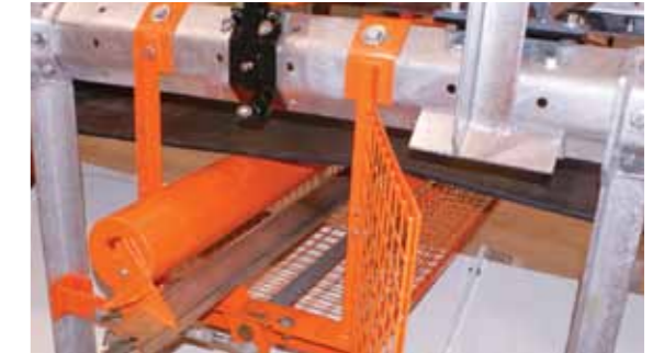
(Şekil 4) Toz birikimine dayanıklı yapı, kaçak malzeme geçişini engeller.
