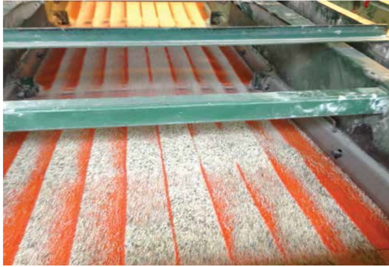
Döküm Kumunun Polyweb® DU Poliüretan Panel ile Sınıflandırılması
