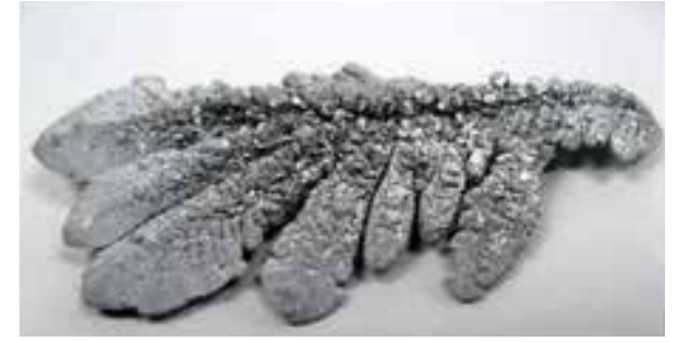
İzabeden elde edilen yapraklı çinko metal
