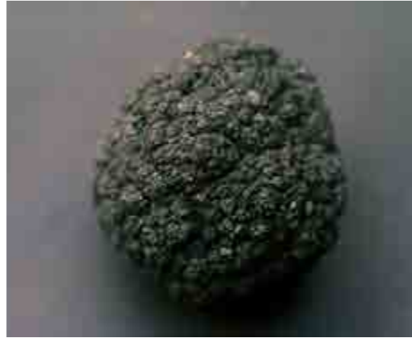
Pasifik Okyanusu'ndan alınan Mn nodülü; manganez, demir, nikel, bakır ve kobalt bakımından zengindir
